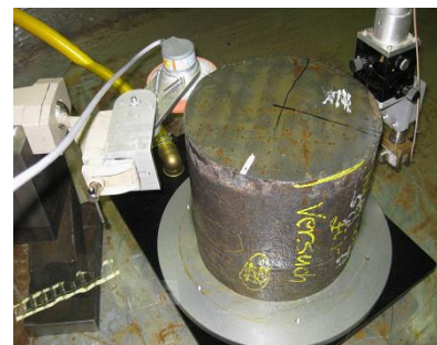
Abb. 11: Einschallschema bei der Stabstahlprüfung in Tauchtechnik
